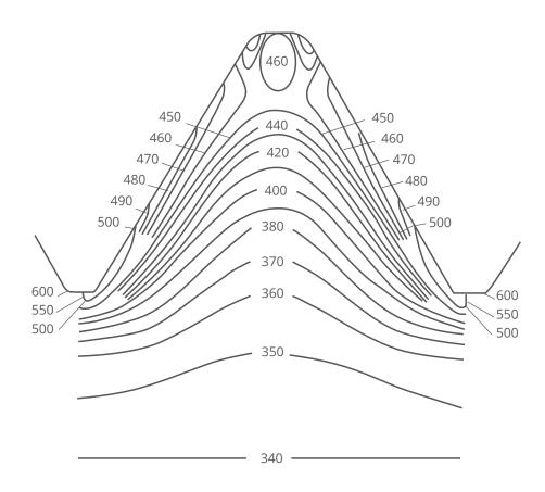
Si bien las normas generalmente permiten que las roscas se realicen tanto por el método de arranque de virutas, como por laminación, éste último proceso es totalmente ventajoso, pues el mismo al producir presión sobre el material no corta las fibras del mismo, reduce la rugosidad de la superficie, aumenta notablemente la resistencia a la fatiga, oxidación y tracción. En la siguiente figura se observa claramente el incremento de dureza superficial (HV 10) producto de la deformación del material.
